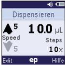
Im Modus Dis wird die aufgenommene Flüssigkeit in definierten Einzelschritten abgegeben.
