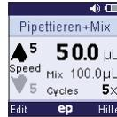
Zusätzlich werden im Display das Mischvolumen (*Mix*) und die Anzahl der Mischzyklen (*Cycles*) angezeigt.
