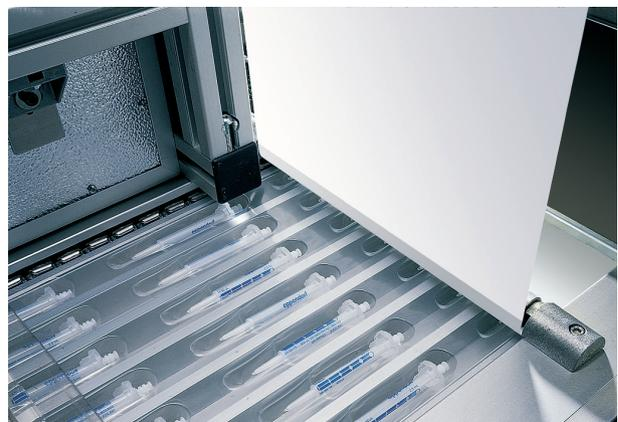
**Abb. 3:** Verpacken von Verbrauchsartikeln des Reinheitsgrades Eppendorf Biopur vor der Sterilisation
