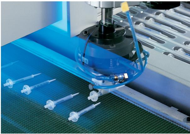
**Abb. 2:** Vollautomatisches Einsortieren von Combitips in die Blisterverpackung unter Reinraumbedingungen.
