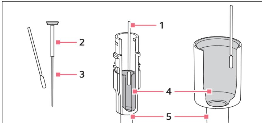
**1 Stäbchen****4 Zylinder****2 Kolben ≤ 20 µL****5 Unterteil > 20 µL****3 Lauffläche**
